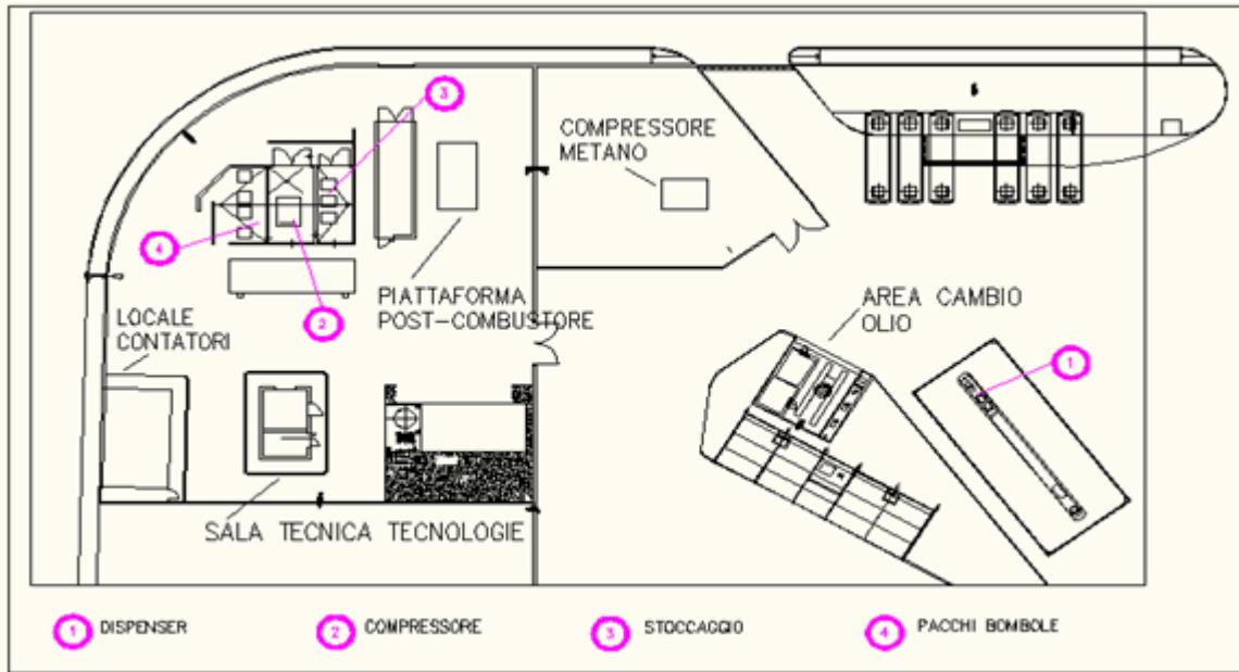
El case study analizado se refiere a una planta piloto, planeada para ser instalada, para el suministro de hidrógeno para vehículos de pilas de combustible. Se ha formulado la hipótesis de una estación de reabastecimiento de hidrógeno de 50 m x 20 m, que opera 300 días al año y donde se reprovisionan 50 vehículos por día una vez al día, para un total de 15,000 reabastecimientos por año.
