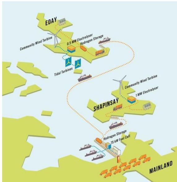
El proyecto BIG HIT ha permitido crear un territorio de hidrógeno en las Islas Orcadas en Escocia mediante la implementación de un modelo totalmente integrado de producción, almacenamiento, transporte y utilización de hidrógeno para calefacción, energía y movilidad.
