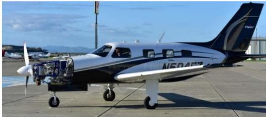
El avión de seis plazas Piper M-class de ZeroAvia se utilizará en las pruebas de vuelo de HyFlyer
