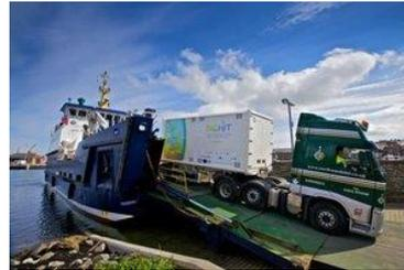
La electricidad renovable generada en las islas de Eday y Shapinsay es utilizada por electrolizadores para producir hidrógeno, por electrólisis de agua. Este hidrógeno se almacena como gas a alta presión en los remolques de tubos, que pueden transportarse a las Orcadas continentales.
